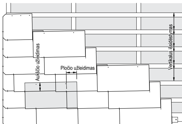
Horizontalus dengimas naudojant 60 x 30 cm formato plokšteles.
